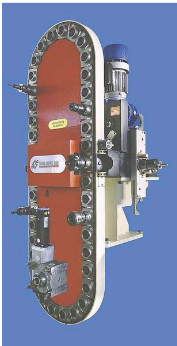
Устройство смены инструмента с магазин инструментов цепного типа.
