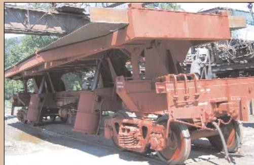
Вторая - спецвагон для перевозки труб. Его конструкция обеспечивает надежное крепление груза, исключая продольные перемещения. Резиновое покрытие на стойках, стенах и ложементах гарантируют сохранность полиэтиленового покрытия труб и фасок
