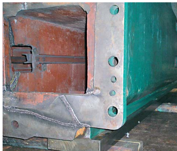
Восстановленная колонна станка
