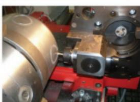
серво-пьеzo-инструмент производства фирмы Cedrat Technologies. А расчет траектории овала поршина (обработка данных с датчиками: обороты шпиндела «S», изменение овала по высоте поршина в оси «Z») и выдачу результатирующего задания на усилитель сер-
